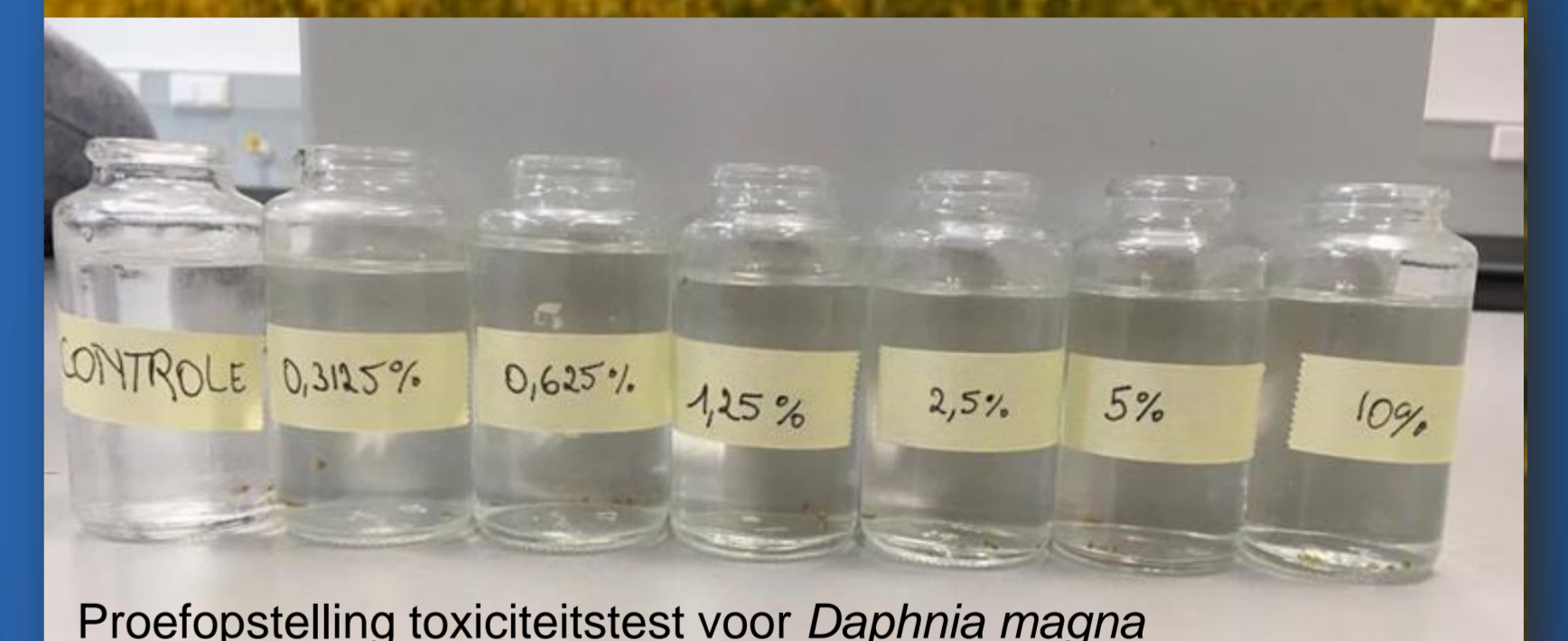
Proefopstelling toxiciteitstest voor Daphnia magna
